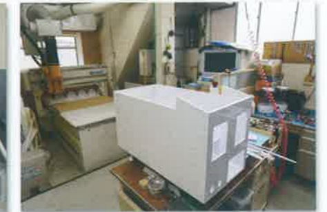
プラスチック板から試作機を生み出す。ガントリー型NCルーター
