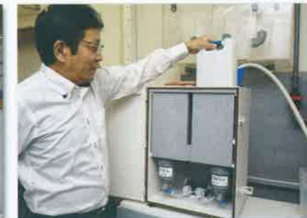
生成機では溶剤を誤って入れることがないように工夫されている
